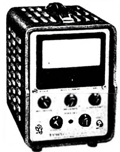
Bild 6. Mikrowellen-Leistungsmesser „650“ (PRD) für 0,1...100 mW ohne äußere Dämpfungsglieder (Genauigkeit \pm 3\% ; ein Schutzrelais sichert den Bolometerfühler gegen Überlast und Verbrennen; Vorspannung für 0...40 mA vorhanden; jedes beliebige Bolometer ist verwendbar)
